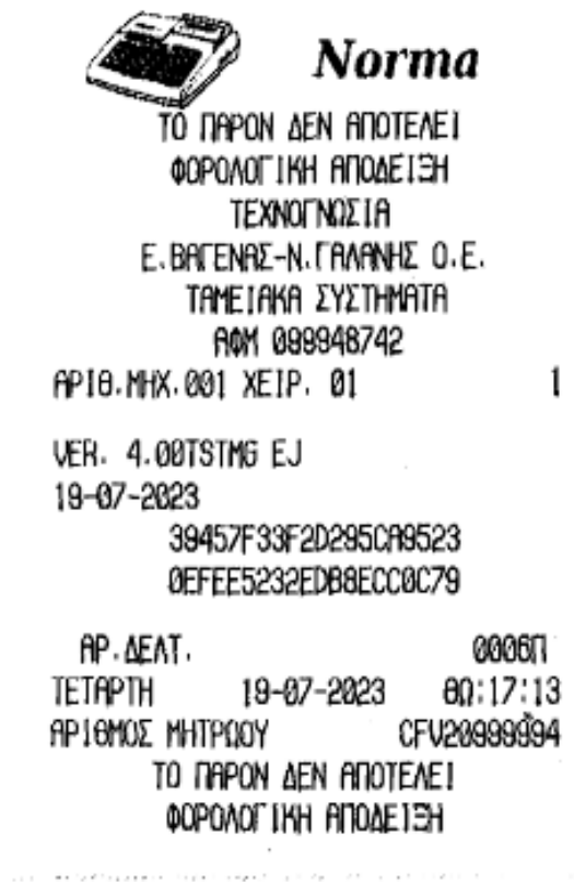
Φωτογραφία #2 Μη φορολογικό δελτίο με τα στοιχεία της έκδοσης, της ημερομηνίας δημιουργίας έκδοσης και την υπογραφή SHA-1 του φορολογικού μικροκώδικα της ΦΤΜ.
